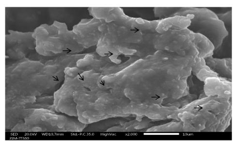
Figure 2. SEM photomicrograph of purified PHB from *Brevibacterium* sp. B45 at 20 kV (Mag. 2000x) Gambar 2. Fotomikrograf SEM hasil pemurnian PHB dari Brevibacterium sp. B45 pada 20 kV (perbesaran 2000x)
